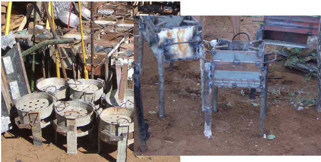
Abb. 4-3: Produktion von Kochherden für die lokale Bevölkerung
