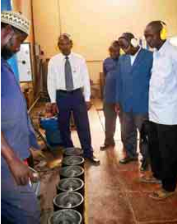
Image 3.7 Changement de pistons à la centrale
