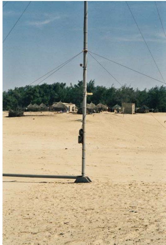
Abb. 4.7: Windmessmast in Mboro sur mer mit einer Höhe von 20 m, der von der ASERA in Kooperation mit einer kanadischen Geberorganisation betrieben wird.
