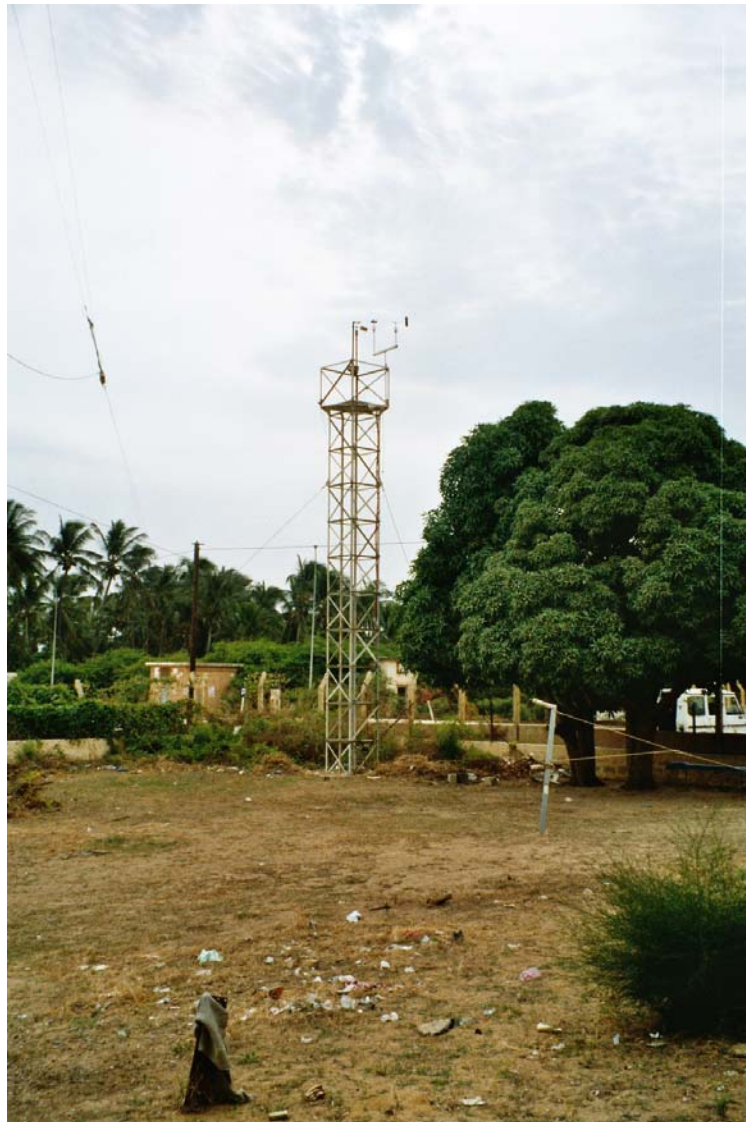
Abb. 4.1: Windmessmast der meteorologischen Station am Flughafen von St. Louis
