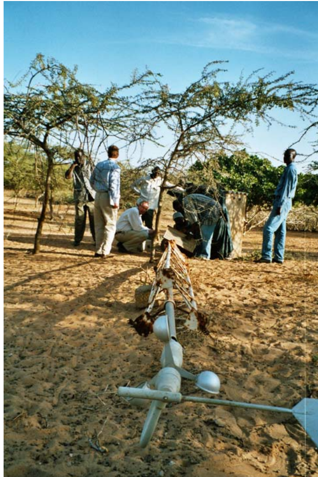
Abb. 4.8: Umgestürzter Windmessmast in Potou mit einer Höhe von 10 m
