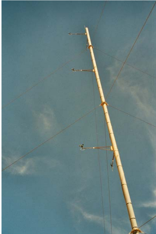
Abb. 4.7: Windmessmast in Mboro sur mer mit einer Höhe von 20 m, der von der ASERA in Kooperation mit einer kanadischen Geberorganisation betrieben wird.
